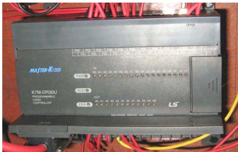
Gambar 3.5 Realisasi bentuk fisik PLC LG Master-K 120S
