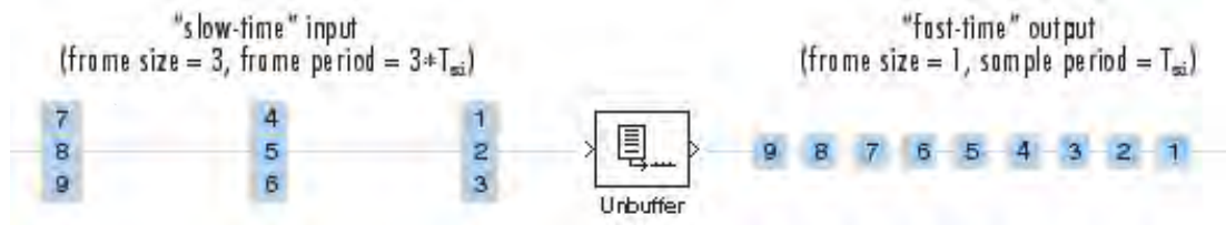
Gambar 3.11. Prinsip kerja dari blok unbuffer [20]
