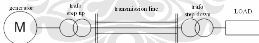
Gambar 2.1 Skema sistem tenaga listrik
