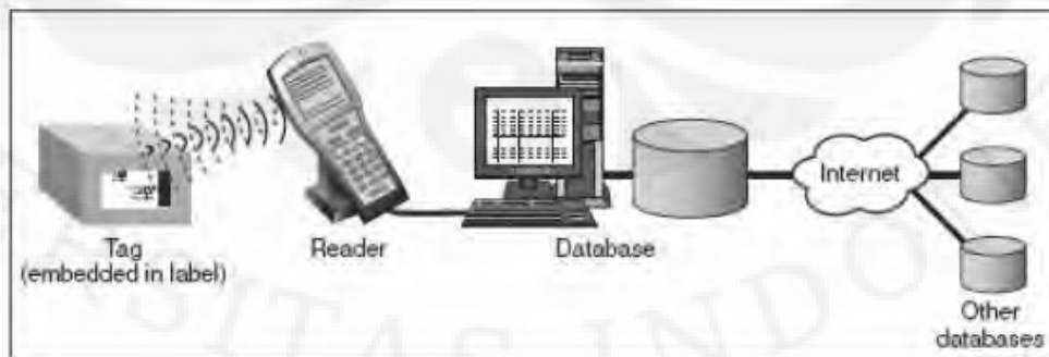
Gambar 2.14. Komponen utama sistem RFID. [14]
