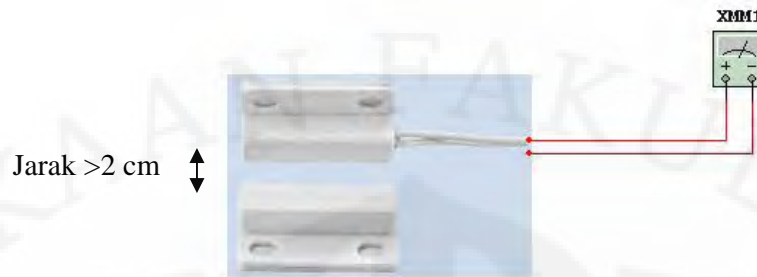
Gambar 4.1. Rangkaian pengujian sensor magnetic switch
