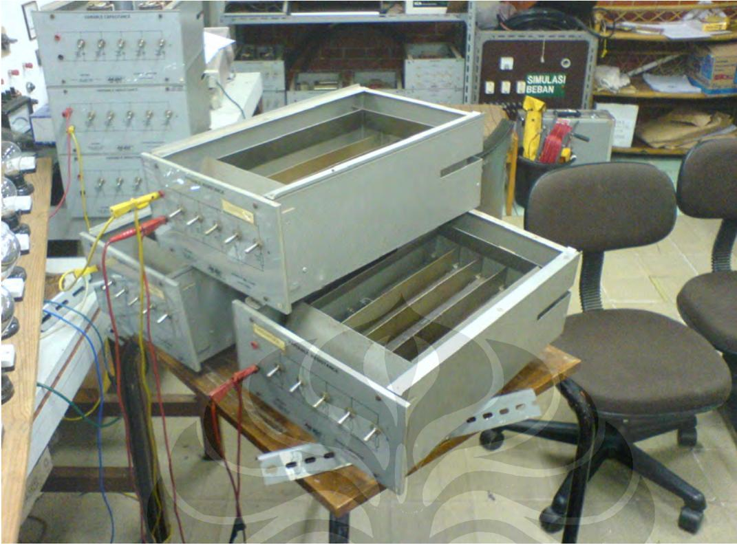
gambar c. foto beban variasi resistif dan induktif
