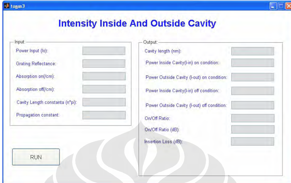
Gambar-3.8. Program menghitung parameter-parameter pada modulator elektroabsorpsi dengan grating .
