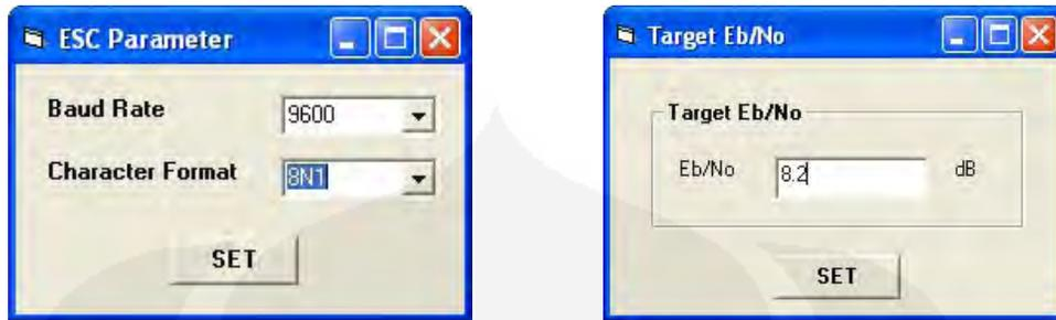
Gambar 4.3. Konfigurasi ESC parameter dan target Eb/No
