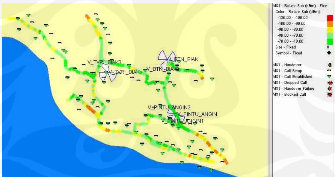
Gambar 3.8. Daerah Cakupan BTS Biak Setelah Pemasangan
