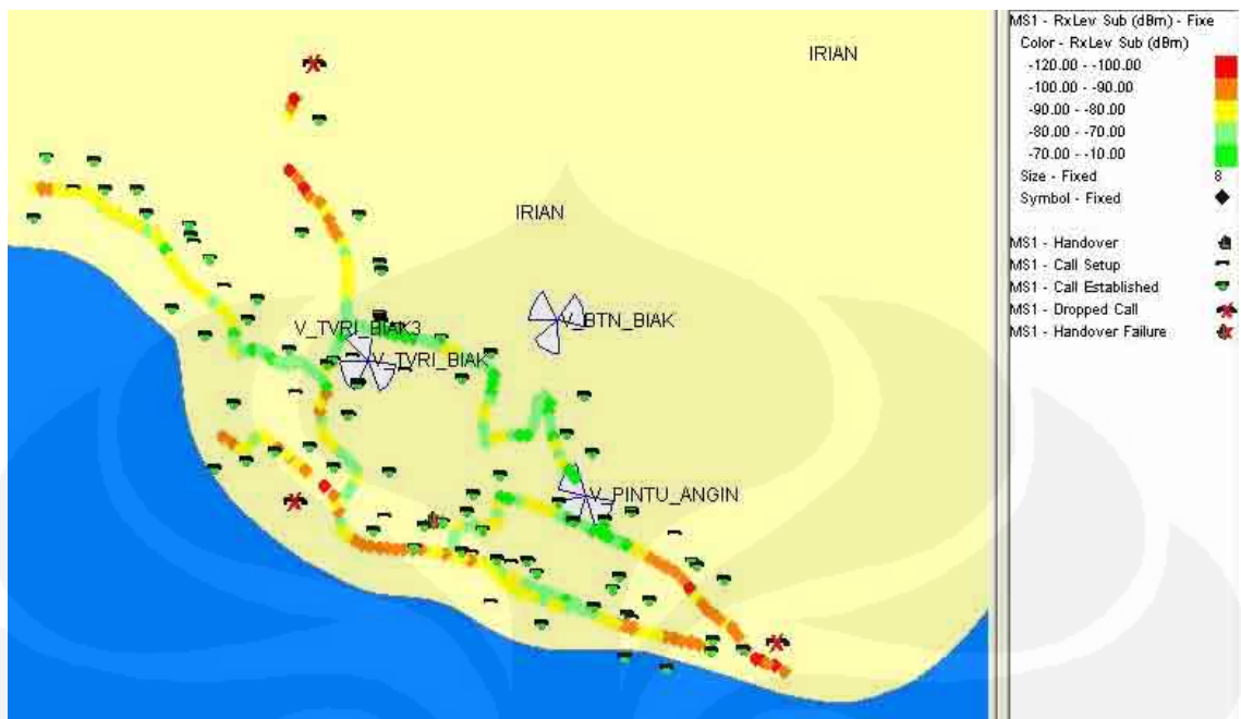
Gambar 3.7. Daerah Cakupan BTS Biak Sebelum Pemasangan
