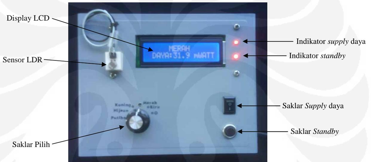
Gambar 4.1 Perangkat keras dari bagian luar
