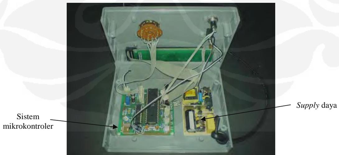
Gambar 4.2 Perangkat keras dari bagian dalam
