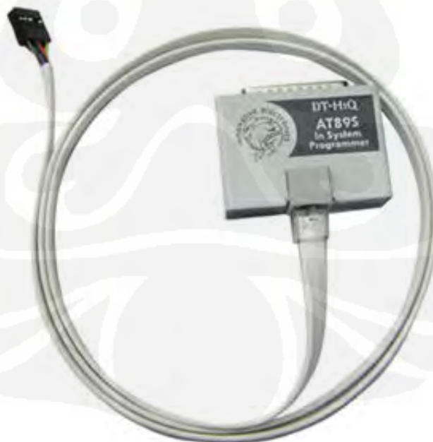
Gambar 3.7 In-System programmer untuk AT89S51 [20]
