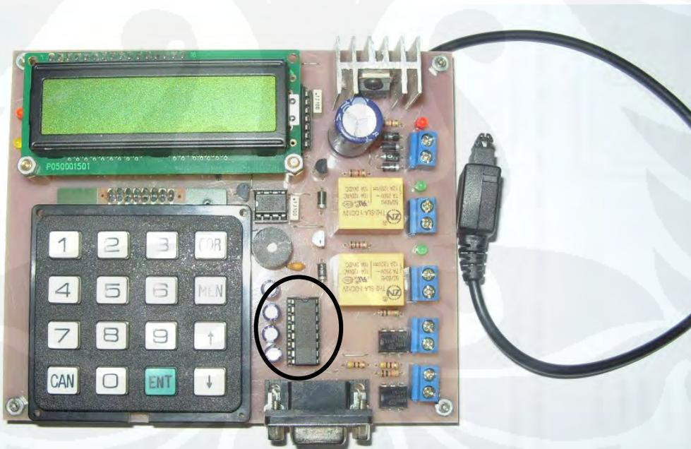
Gambar kondisi kerja Alat bila menggunakan modem (adanya penambahan IC)
