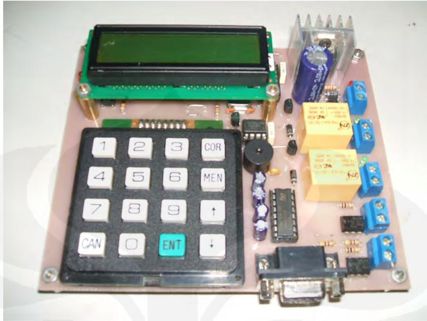
**Gambar 4.1.** Modul alat pengendali *Switch Breaker*
