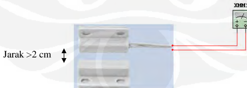
Gambar 4.1. Rangkaian pengujian sensor magnetic switch
