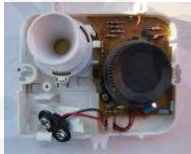
Gambar 2.16 Bentuk dan contoh Ionization Smoke Detector [8]
