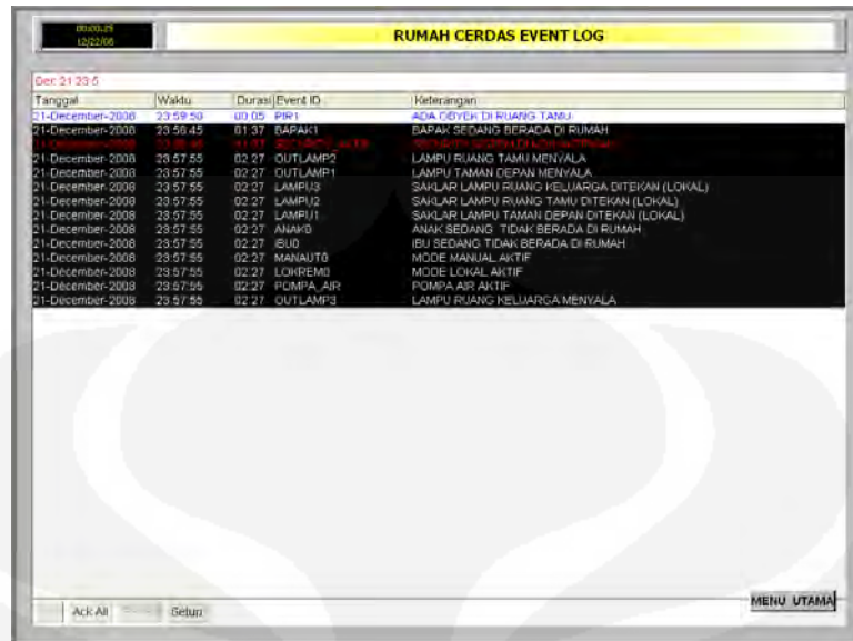
Gambar 4.8. Tampilan event log pada SCADA
