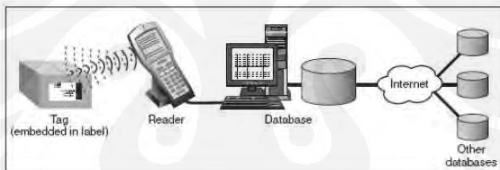
Gambar 2.10. Komponen utama sistem RFID. [3]
