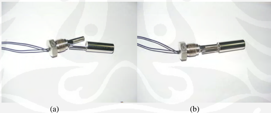
Gambar 2.13 Bentuk dan contoh level switch
