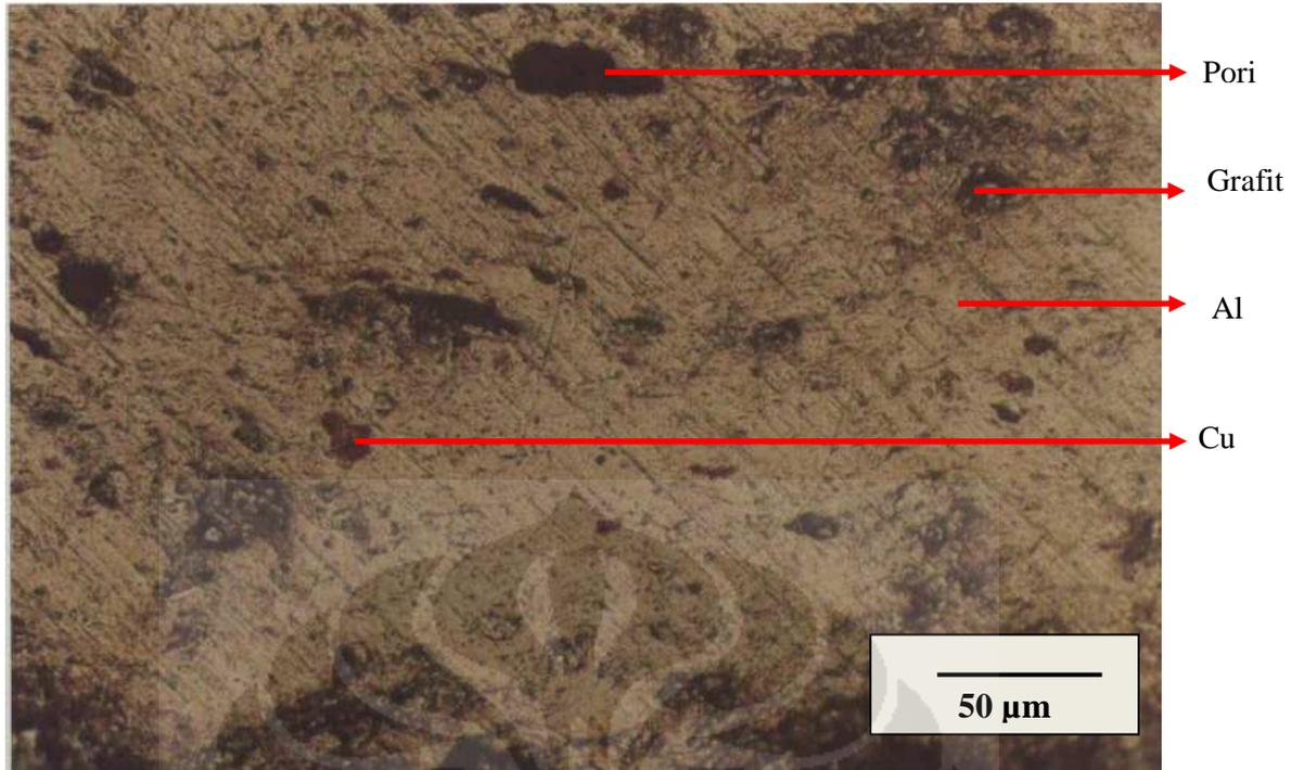
**Gambar 4.11.** Struktur mikro dari Al + 3 %Vf C perbesaran 100x (non-sinter)
