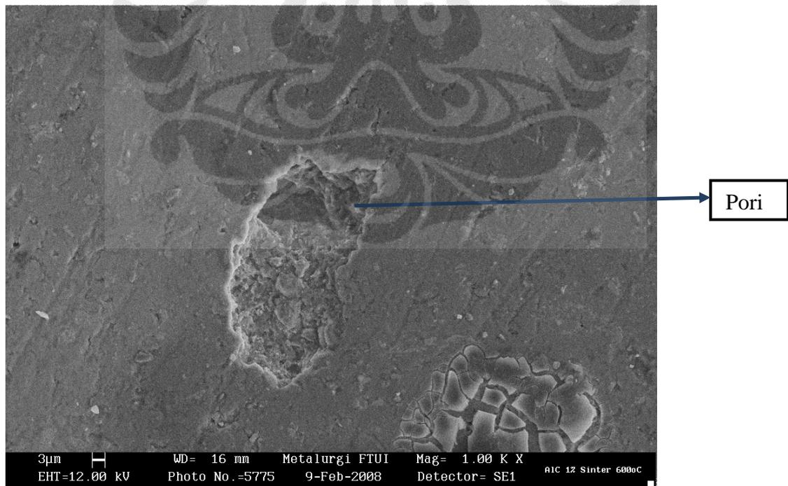
**Gambar 4.28.** Struktur mikro dari Al + 1 % Vf C perbesaran 1000x (sinter)
