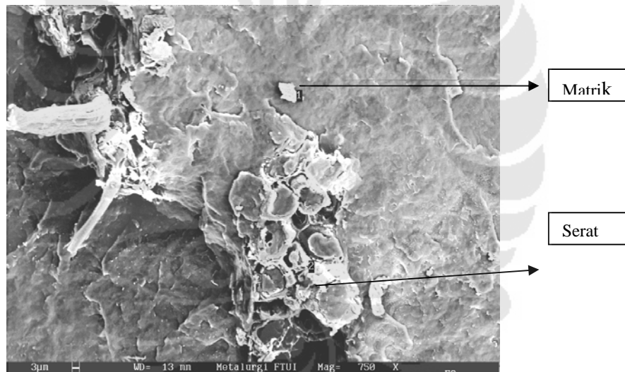
Gambar 4.9. Hasil pengamatan struktur mikro menggunakan EDX produk WPCs dengan ukuran bahan pengisi 250 \mu\text{m} (F5)
