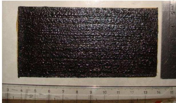
**Gambar 5.1** Permukaan lapisan *glass flake epoxy* pada substrat baja setelah proses *curing* selama 7 hari
