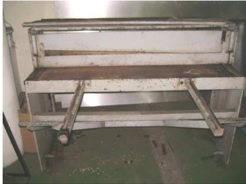
**Gambar 3.2.** Alat Pemotong Pelat
