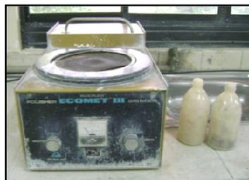
**Gambar 3.10.** Mesin Amplas
