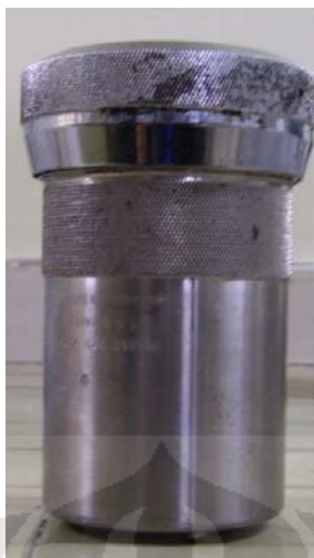
Gambar 3.4 Container yang digunakan pada proses hidrotermal.
