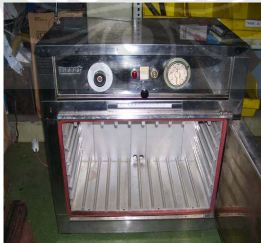
Gambar 3.3 Oven Memmert yang digunakan pada proses pengeringan dan hidrotermal.
