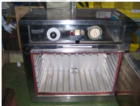
**Gambar 3.5.** Oven yang digunakan pada proses pengeringan dan hidrotermal
