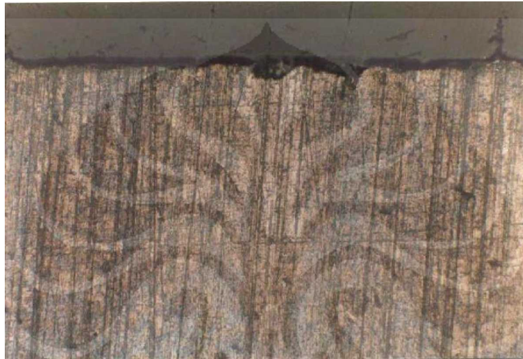
Baja SRK T3 pada lingkungan pH 3, tegangan aplikasi 222 MPa. (perbesaran 200x)
