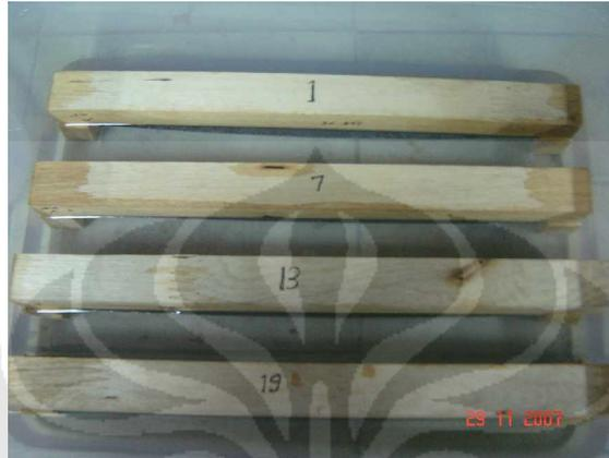
**Gambar 3.6.** Susunan sampel pengujian korosi.
