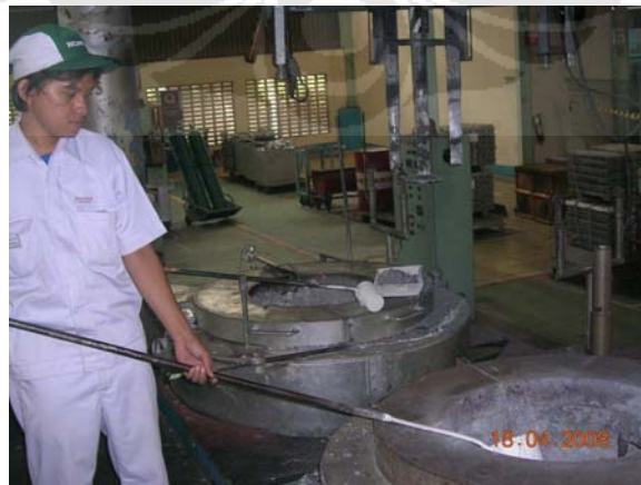
Gambar 3.5 Proses penambahan Sr dalam aluminium cair
