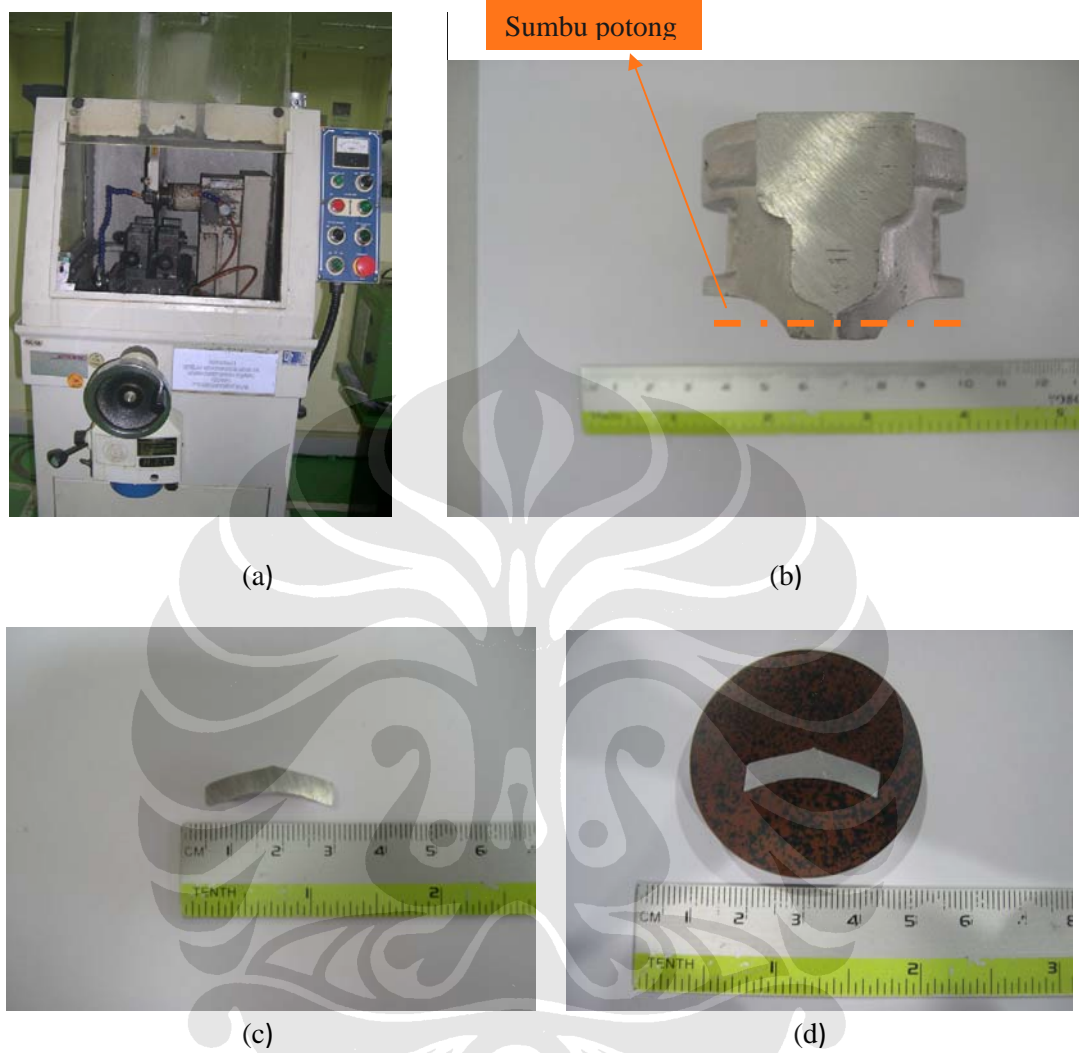
Gambar 3.7. (a) Mesin potong dengan coolant, (b) Sumbu potong piston, (c) Hasil potongan sampel, (d) Sampel foto mikrostruktur
