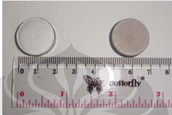
Gambar 3.4. Sampel green compact (kiri) dan burn compact (kanan)
