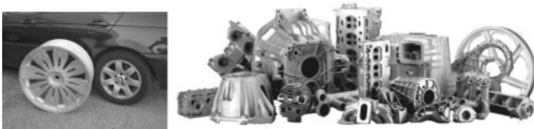
**Gambar 2.14** Contoh komponen otomotif hasil proses LPDC<sup>[12]</sup>
