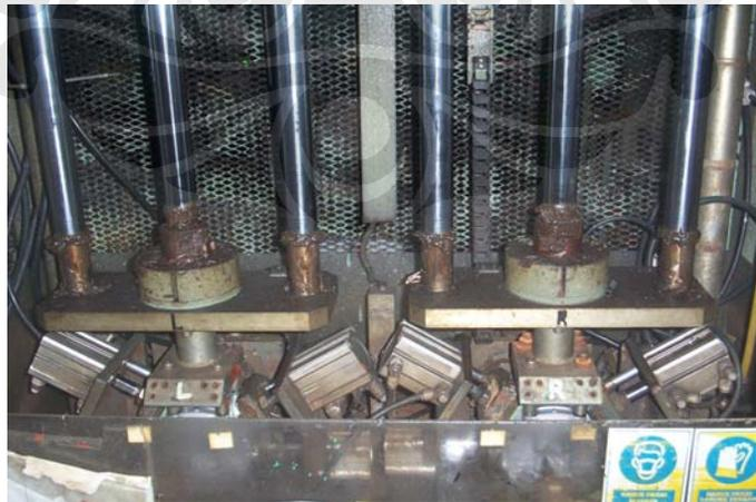
Gambar 3.6 Alat uji bocor
