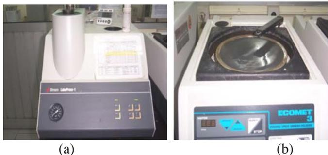
**Gambar 3.7.** (a) Alat *Compression Mounting*, (b) Alat ampelas dan poles
