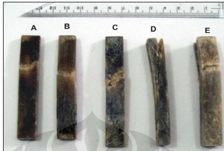
Gambar 4.6 Gambar sample setelah mengalami patah akibat uji tekan,. (A) konsentrasi 15 % Vf serat rami, (B) konsentrasi 20 % Vf serat rami, (C) konsentrasi 25 % Vf serat rami, (D) konsentrasi 30 % Vf serat rami, (E) konsentrasi 35 % Vf serat rami
