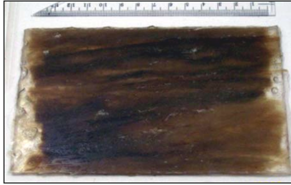
Gambar 4.2 Hasil Fabrikasi Poliester - Rami pada cetakan 14 cm x 9 cm x 0.4 cm untuk cetakan uji flexural. (a) konsentrasi 30 % Vf serat rami, (b) konsentrasi 20 % Vf serat rami
