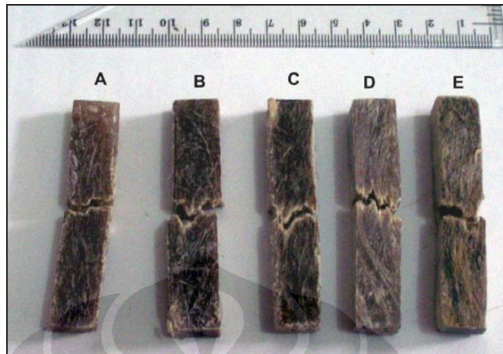
Gambar 4.4 Gambar sample setelah mengalami patah akibat uji impak,. (A) konsentrasi 15 % Vf serat rami, (B) konsentrasi 20 % Vf serat rami, (C) konsentrasi 25 % Vf serat rami, (D) konsentrasi 30 % Vf serat rami, (E) konsentrasi 35 % Vf serat rami
