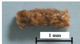
Gambar 4. 2 Pellet WPC memiliki permukaan yang kasar
