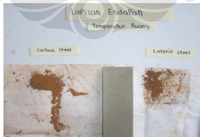
Gambar 4.2 Lapisan karat pada permukaan baja karbon dan baja laterit pada temperatur ruang
