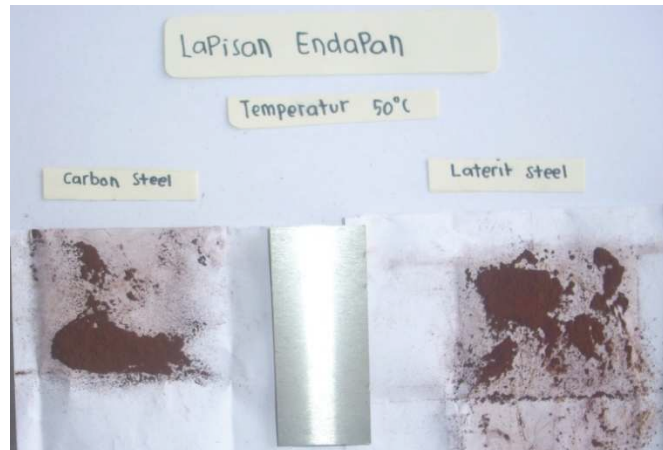
Gambar 4.3 Lapisan karat pada permukaan baja karbon dan baja laterit pada temperatur 50°C
