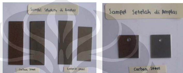
**Gambar 3.5** Sampel Sebelum dan setelah diampelas
