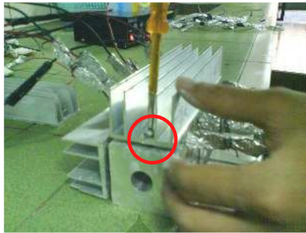
Gambar 5.4 Lubang baut yang mengalami keausan.
