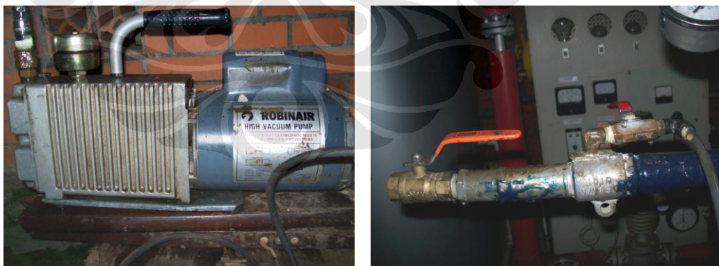
Gambar 3.12 Pompa Vakum dan Ejektor Udara
