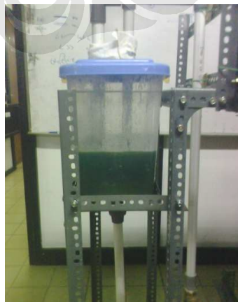
Gambar 3.12 Reservoir untuk menampung larutan \text{CuSO}_4 .
