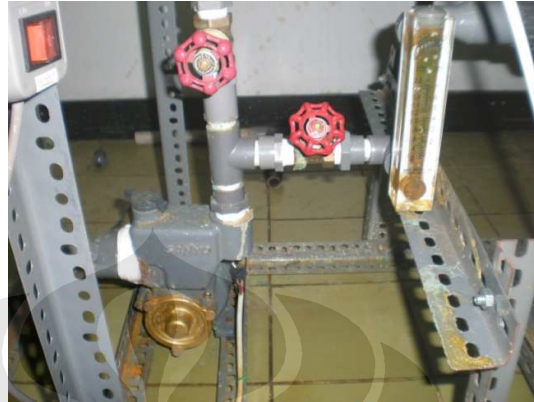
Gambar 3.10 Pompa yang digunakan beserta letak katup untuk mengatur laju aliran
