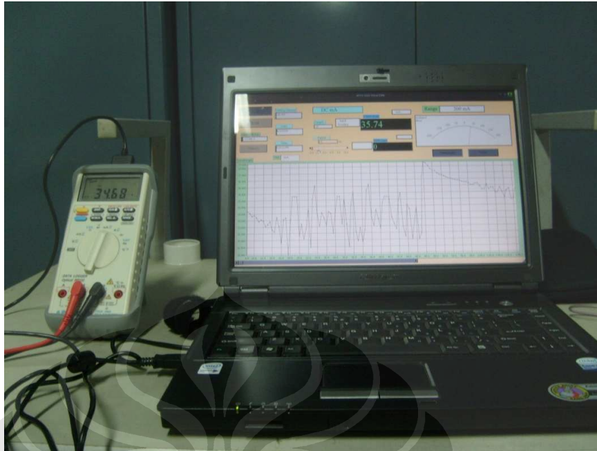
Gambar 3.16 Digital multimeter yang digunakan dan software yang digunakan untuk membaca data di komputer
