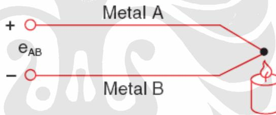
Gambar 3.7. Perbedaan tegangan antara kedua kawat karena perbedaan temperatur
