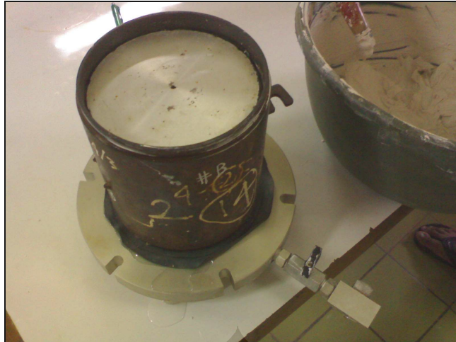
Cetakan sampel contoh tanah yang telah siap untuk dilakukan proses pemadatan dengan alat rowe cell .
