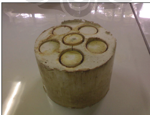
Sampel contoh tanah kaolin yang telah dikeluarkan dari cetakannya setelah proses pemasukan cetakan benda uji triaksial.
