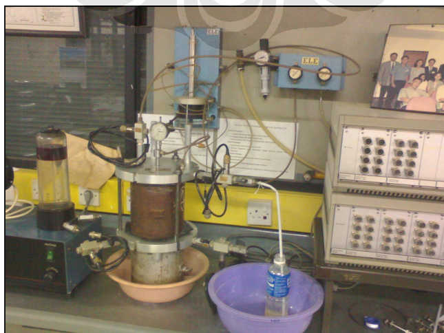
Sampel contoh tanah yang sedang dalam proses pemadatan dengan menggunakan alat rowe cell yang telah dimodifikasi.
