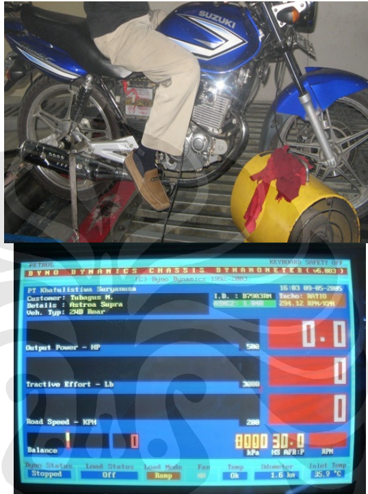
Gambar 3.7 proses pengambilan data dengan Dynamometer
