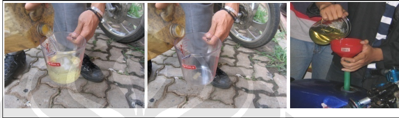
Gambar 3.9 Pengukuran konsumsi bahan bakar
