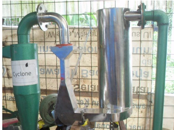
Gambar 4.2 Penerapan sistem venturi scrubber pada laboratorium gasifikasi
