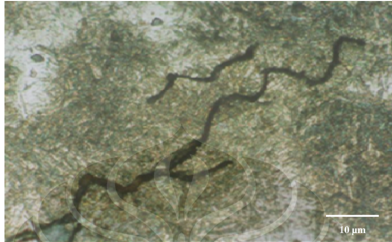
Gambar 4.6 retak mikro dari sampel C, 3.081 %Si setelah flame hardening
