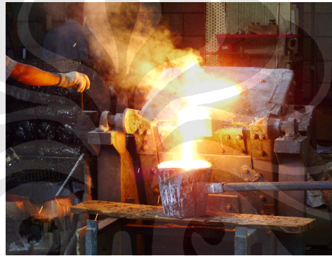
Gambar 3.3. Proses peleburan dengan dapur induksi pada temperatur 1650°C
