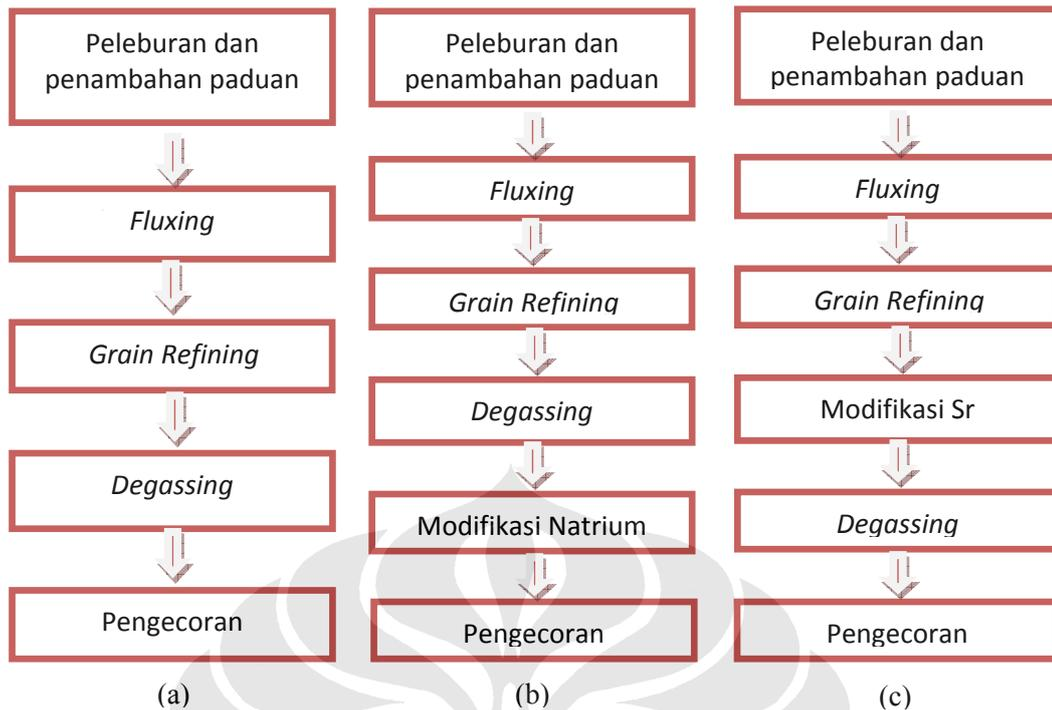
Gambar 2.5 Penempatan Penghalus butir pada proses pengecoran Aluminium<sup>[3]</sup>:
