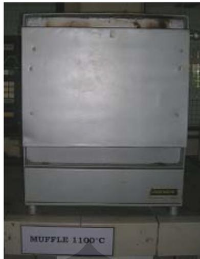
Gambar 3.5 Dapur Pemanas Induksi Nabertherm
