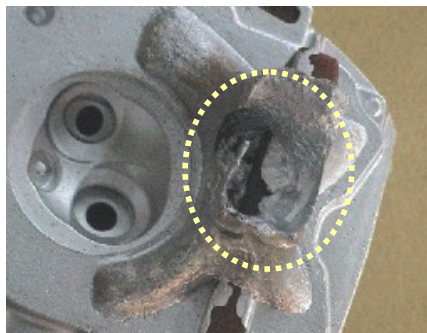
Gambar 2.12. Kondisi misrun gate
