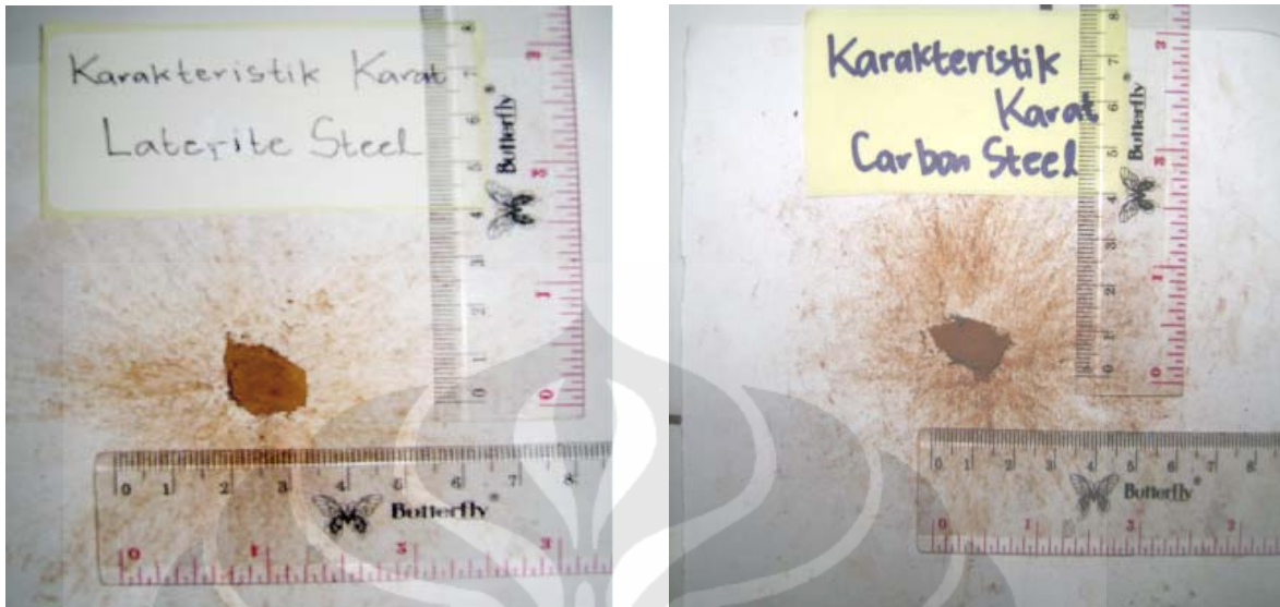
Gambar 3.14 Produk korosi sampel baja untuk pengujian EDX
