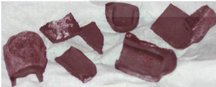
**Gambar 4.9** Potongan produk CMCs hasil firing dengan waktu tahan 24 jam
