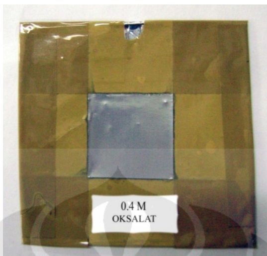
Gambar 4.2 Foto sampel setelah dianodisasi dengan larutan elektrolit asam oksalat 0.4 Molar
