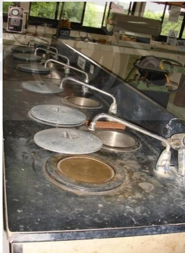
**Gambar 3.5** Mesin amplas dan poles
