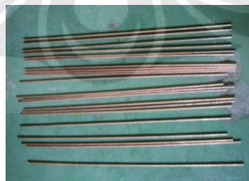
Gambar 3. 3 Pipa tembaga yang telah dipotong
