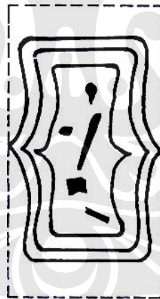
Gambar 2.6 Pembentukan fasa intermetalik yang tersebar dalam liquid yang tertutup [7]
