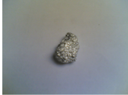
Gambar 3.8 Master alloy Al-80%Fe yang siap ditambahkan kedalam aluminium cair
