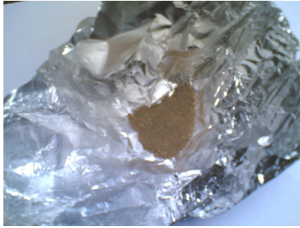
Gambar 3.7 Master alloy Al-80%Fe yang telah digerus dan siap dibungkus aluminium foil
