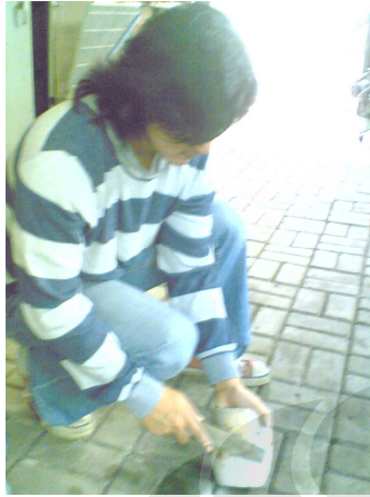
Gambar 3.2 Pembersihan peralatan menggunakan sikat kawat
