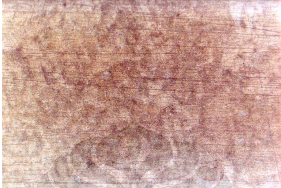
Foto Mikro Struktur Paduan A Q/T 690 o C Perbesaran 100X etsa nital 4%
