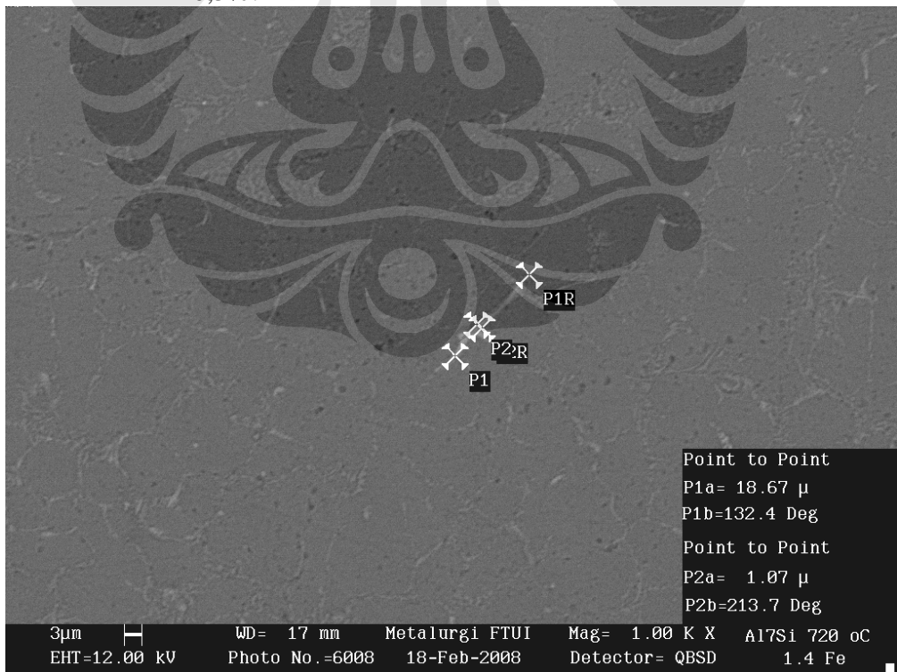
Gambar 9 Pengukuran panjang intermetalik pada Al-7%Si-1,2%Fe. 1000x, etsa HF 0,5%.
