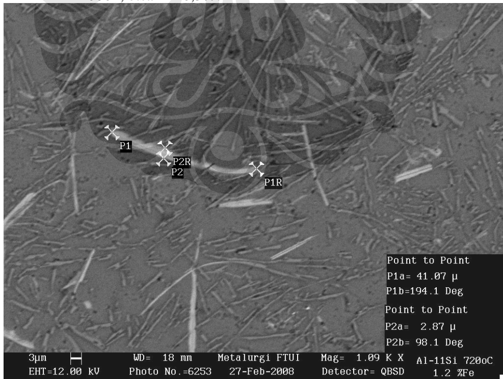
Gambar 16 Pengukuran panjang intermetalik pada Al-11%Si-1,2%Fe. Perbesaran 1000x, etsa HF 0,5%.
